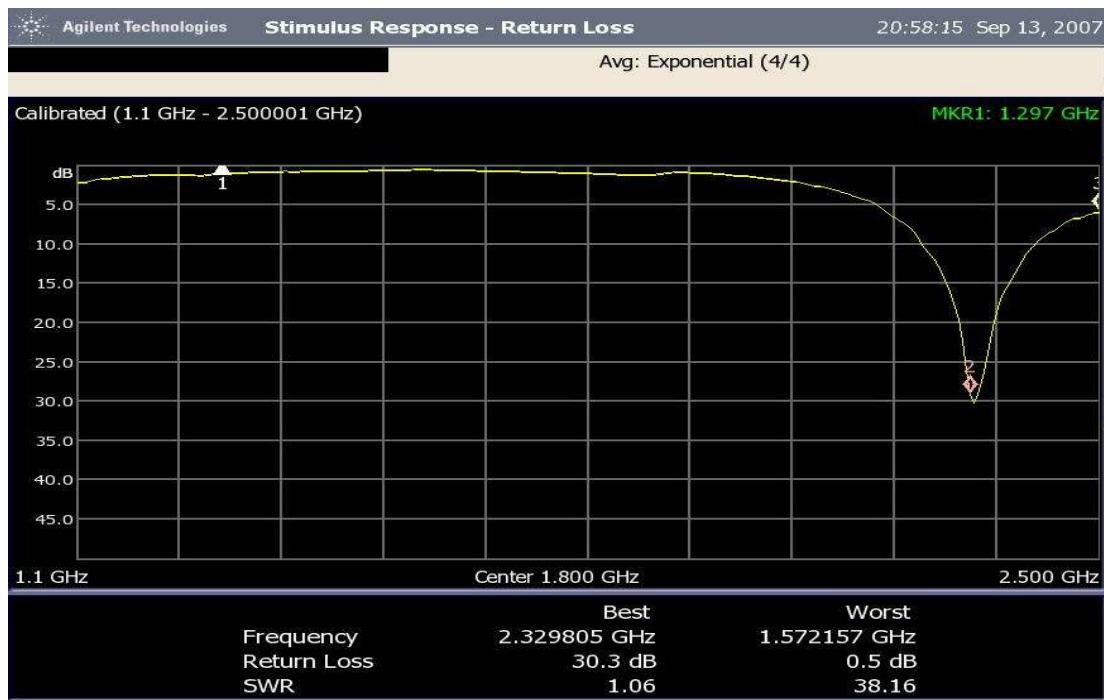
Obr. 12 – Odrazy v pásme 13 cm pre voľný priestor (Marker 2, 2318 MHz: 27,4 dB)
