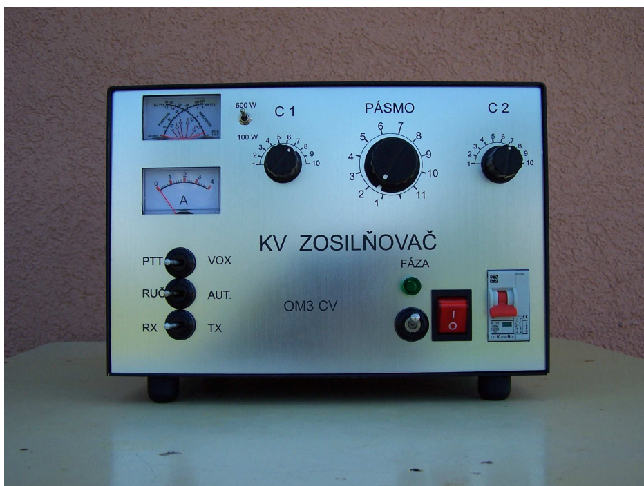
Čelný pohľad na hotový KV PA. Vilo ho nazýva „PA, nič jednoduchšie“
