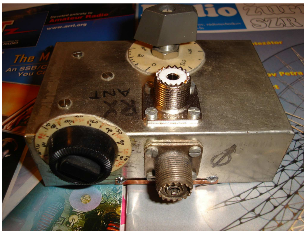
Obr. 4. Pohľad na mostík zo strany konektora meracieho prístroja.
