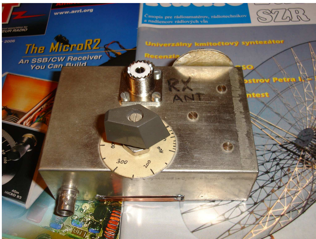
Obr. 3. Pohľad na mostík zo strany konektora generátora.
