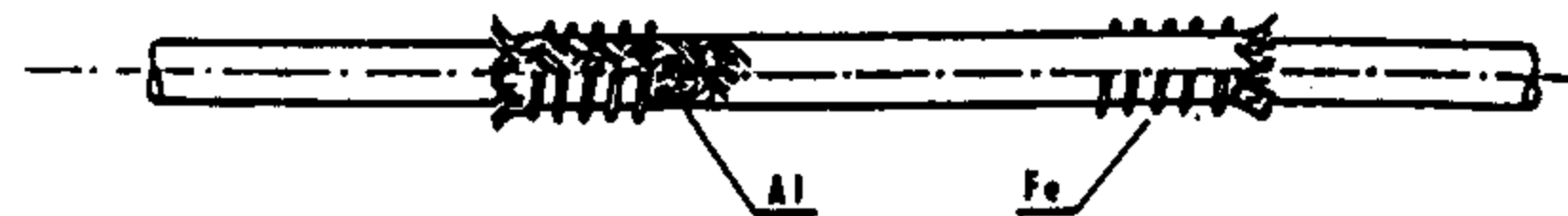
Obr. 7. Spojenie Al tyčiek pomocou Al punčošky
